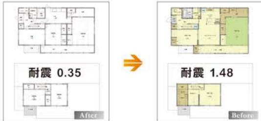
・壁量不足・シロアリ・地盤沈下 ⇒ 筋交い・金物・杭基礎
