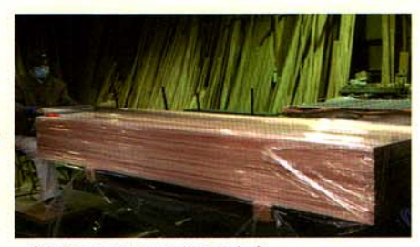
⑥梱包してSWPパネルの完成
